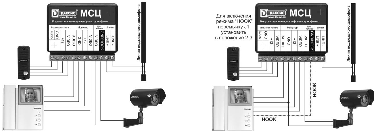
При подключении по правой схеме, не забудьте перевести перемычку J1 в положение 2-3, при этом назначение клеммы 10 переключится из GND во вход сигнала HOOK. Общий провод сигнального кабеля подъездного видео нужно подключать к любой другой клемме GND (2 или 6) в такой конфигурации. Данная схема подключения действительна только для модулей сопряжения МСК версии 1е и выше.
