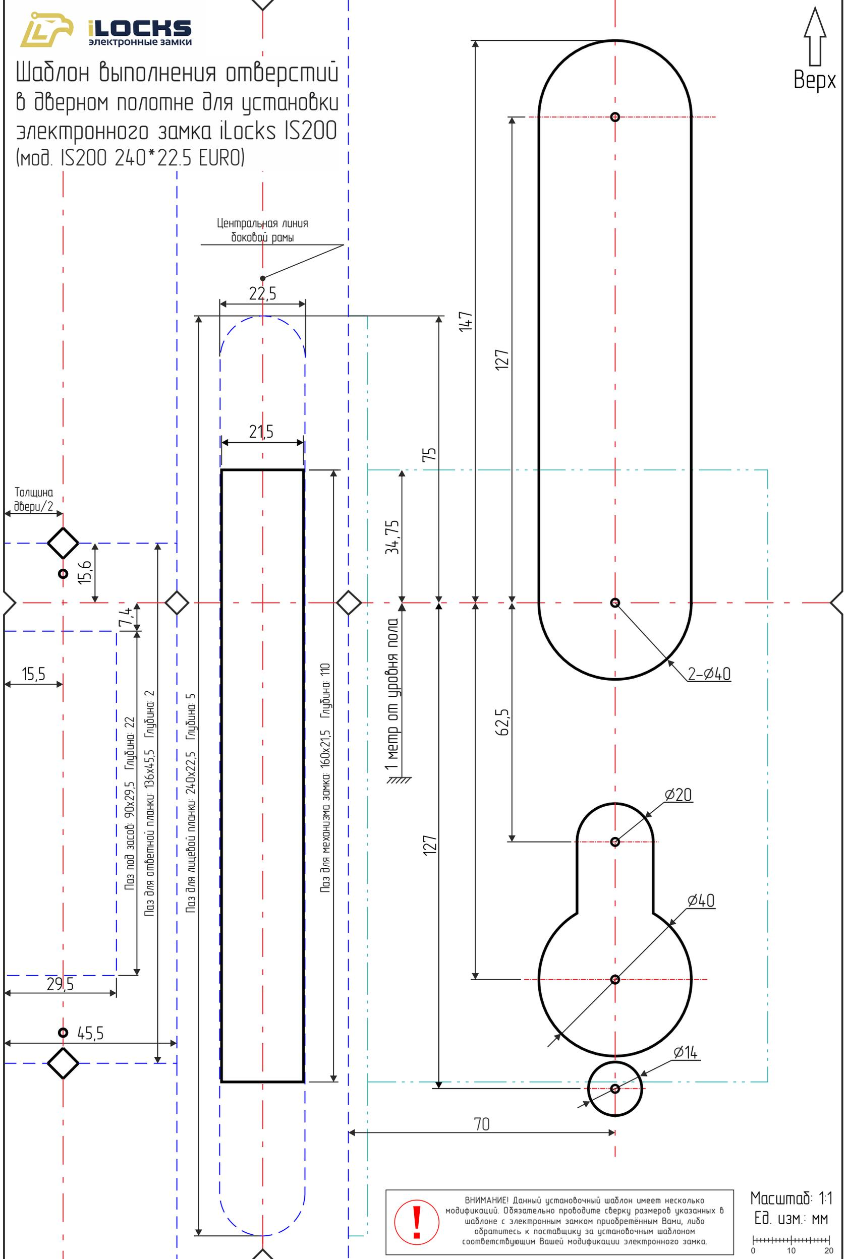
**!** ВНИМАНИЕ! Данный установочный шаблон имеет несколько модификаций. Обязательно проводите сверку размеров указанных в шаблоне с электронным замком приобретенным Вами, либо обратитесь к поставщику за установочным шаблоном соответствующим Вашей модификации электронного замка.
