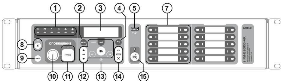
Рисунок 4 – Лицевая панель моделей Sonar SPM-B20xxx-xx (20 зон)
