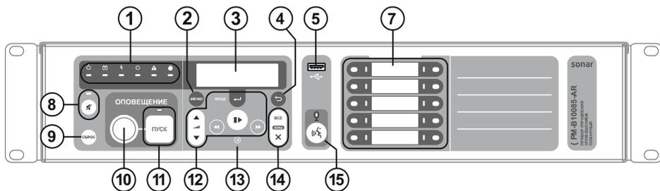
Рисунок 3 – Лицевая панель моделей Sonar SPM-B10xxx-xx (10 зон)
