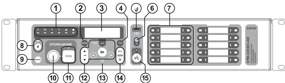
Рисунок 5 – Лицевая панель моделей Sonar SPM-C20xxx-xx (20 зон)
