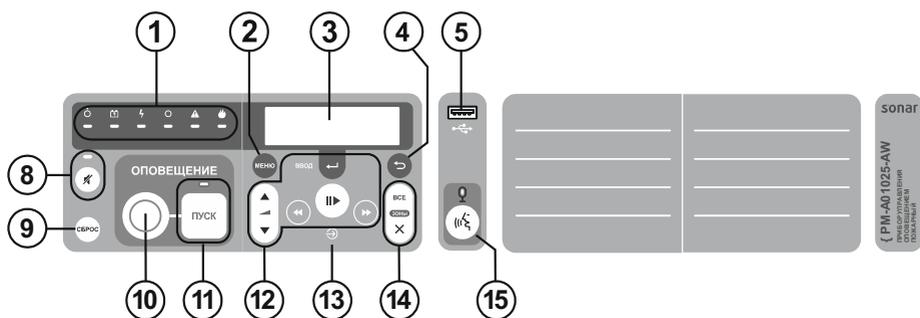
Рисунок 2 – Лицевая панель моделей Sonar SPM-A01xxx-xW (1 зона)
