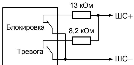
Включение датчиков протечки жидкости в ШС типа 17 ("Водосигнальный")
