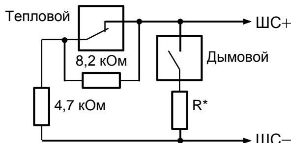
$R^* = 0$  для ДИП-ЗМ, ДИП-ЗСУ, ДИП-У, 2100, 2151Е (напряжение на сработавшем извещателе > 4В)
