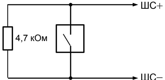
Включение кнопки ВЫХОД и датчика открывания двери в ШС1 при использовании контроля доступа.
