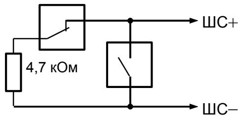
Включение охранных извещателей с блокировочными контактами в ШС типа 5 ("Охранный с контролем блокировки")
