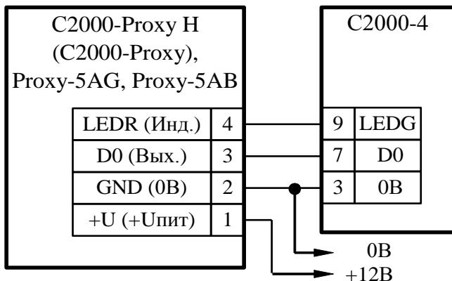
**Схема подключения C2000-Proxy, C2000-Proxy H, Proxy-5AG, Proxy-5AB**
