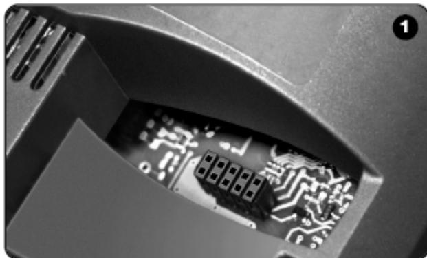
Данные модели связаны с блоком управления при помощи соединения, специфического для данного блока (рис. 1).
