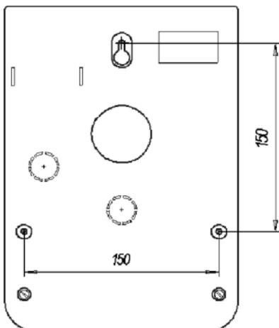
Расположение отверстий для крепления на основании оповещателя.
