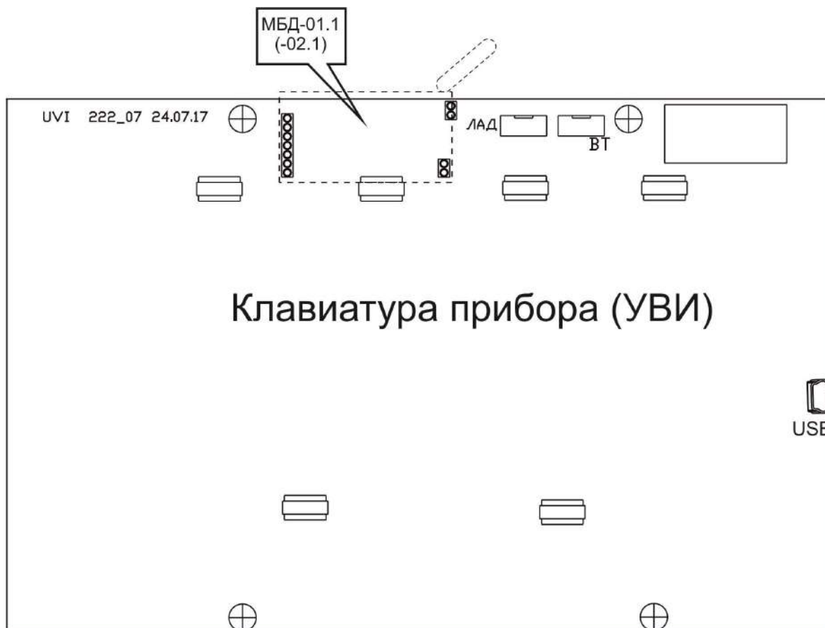
Рисунок Б.3 - Установка модулей беспроводных датчиков на плату УВИ
