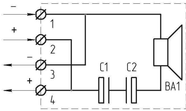
$R_{дин.} = 4 \Omega\text{ или }8 \Omega\text{ (определяется при заказе)}$ .
