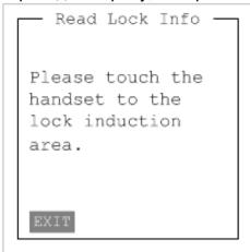
Затем поднести ручной программатор к области индукции замка. По окончании операции прозвучит один соответствующий звуковой сигнал; затем раздастся один короткий и один длинный звуковой сигнал. На ЖК-дисплее отобразится информация о замке.
