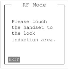
» Поднести ручной программатор к замку; раздастся один звуковой сигнал, замигает зеленый индикатор на ручном программаторе и на ЖК-дисплее появится сообщение «Reading....» (Считывание....). Необходимо держать ручной программатор близко к замку и не убирать его от замка.
