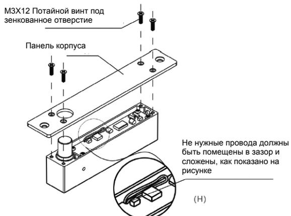
Установите крышку корпуса и закрепите ее винтами, как показано на рисунке H.
