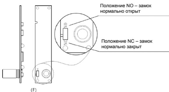
Согласно положению корпуса, установите переключатель на задней стороне платы управления, как показано на рис. F.
