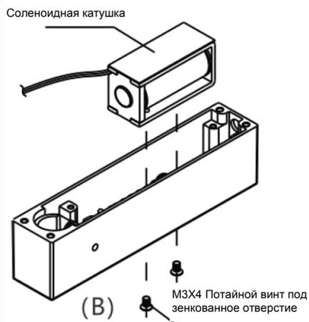
1. Открутите винты в нижней части корпуса замка, как показано на рис. В.
