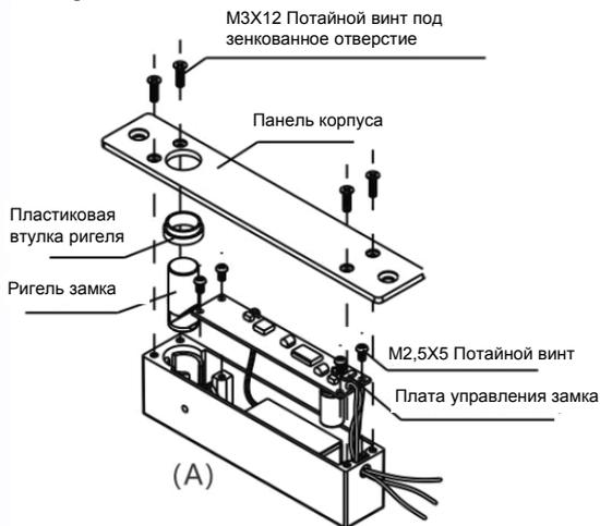
1. Как показано на рис. А, открутите потайные винты М3х12мм (4 шт.) и снимите панель замка.
