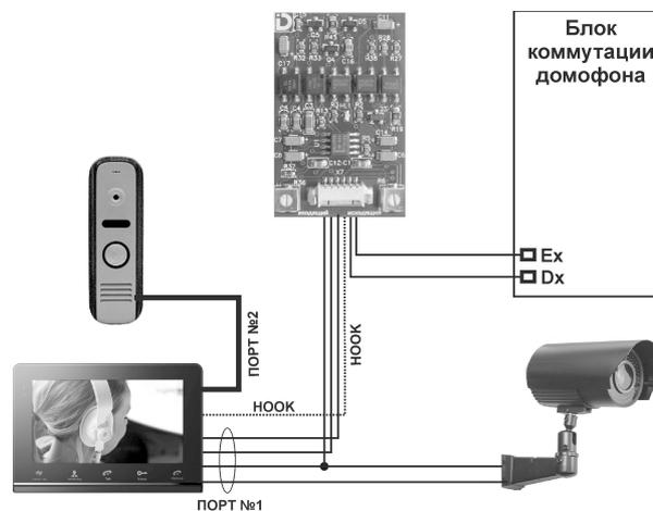
Подключите модуль сопряжения к остальному оборудованию, как показано на схеме. Если выход сигнала "НООК" в Вашем видеодомофоне не предусмотрен, зелёный провод никуда не подключайте.
