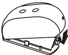
12 При тестировании системы сигнализации в начальный период эксплуатации (1-2 недели) в случае выдачи ложных извещений "Тревога", связанных с особенностями охраняемого помещения, снять крышку извещателя и установить более низкий уровень чувствительности (таблица 2)
