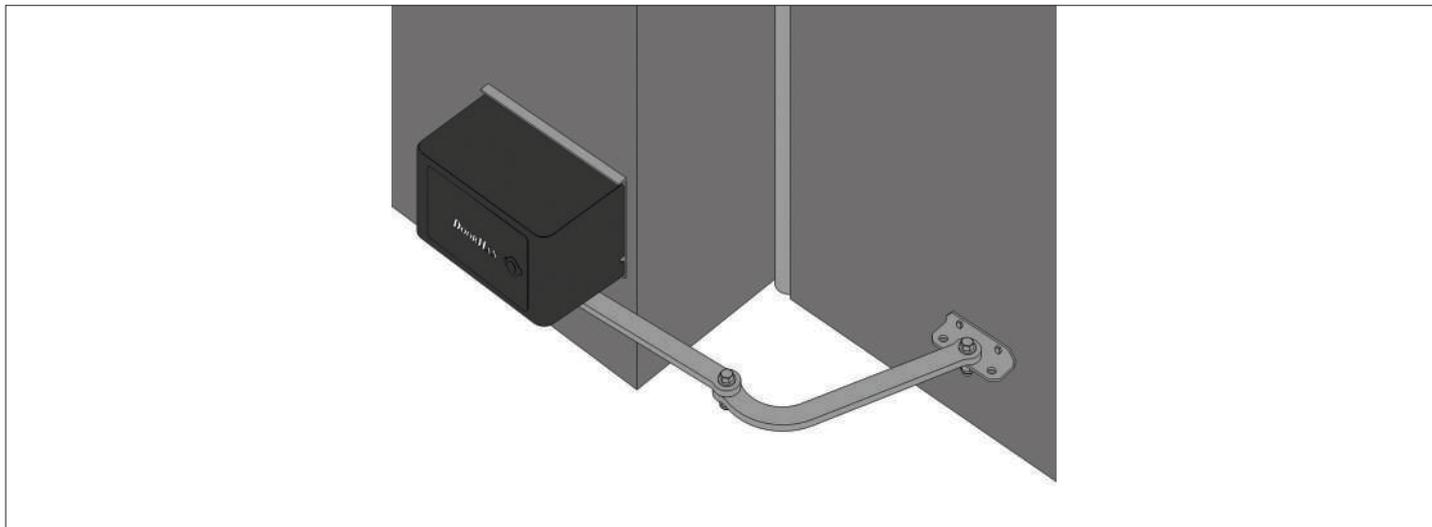
МОНТАЖ НА СТВОРКУ ОТКРЫТИЕ ВНУТРЬ / INSTALLATION ON GATE PANEL, OPENING INSIDE
