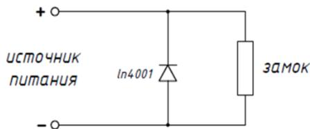
Для избежания помех, создаваемых переключением индуктивной нагрузки электромеханического замка, рекомендуется подключать обратный диод, (например, диод выпрямительный In4001).
