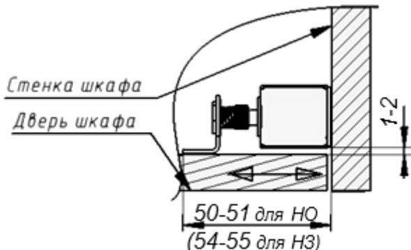
1. Установить замок на неподвижной поверхности.
