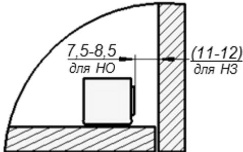
1. Установить замок на неподвижной поверхности.
