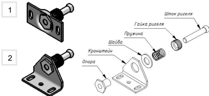
Ригель поставляется в собранном состоянии **1**, и подходит для установки на распашные двери и выдвижные ящики. Для раздвижных дверей типа «шкаф-купе» рекомендуется использовать положение **2**. Установка ригеля на кронштейн угловой осуществляется потребителем согласно приведенной выше схемы.
