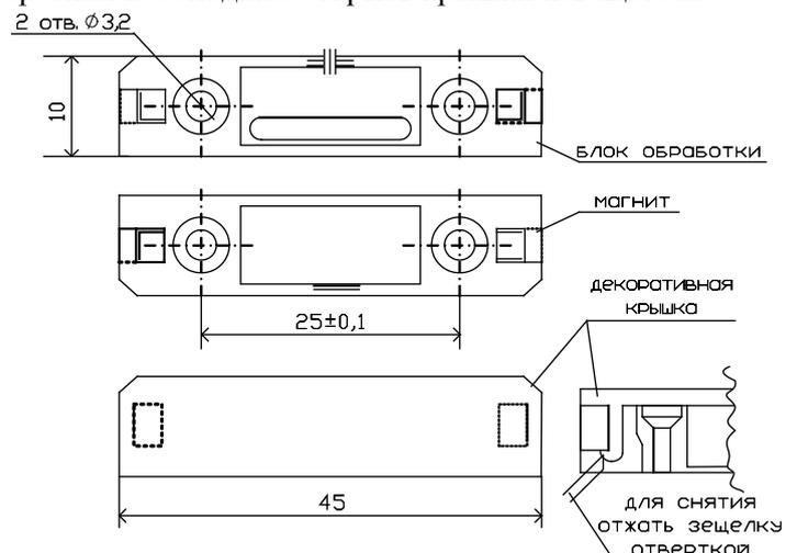
Рисунок 2 Установочные размеры
