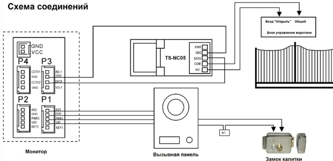
**Внимание:** при подключении электронного реле к блоку управления воротами требуется соблюдать полярность. Запрещается подключать устройства имеющие потребляемый ток выше 5mA.
