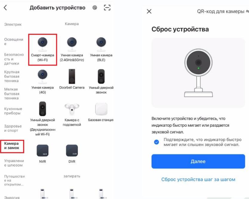
Перезагрузите камеру отключив её от питания и включив вновь. Примерно через минуту после включения, камера произнесет «**Wait for Wi-Fi Config**». Нажмите на подтверждающую надпись в нижней части экрана приложения о том, что индикатор быстро мигает или слышен звуковой сигнал. Нажмите **Далее**.
