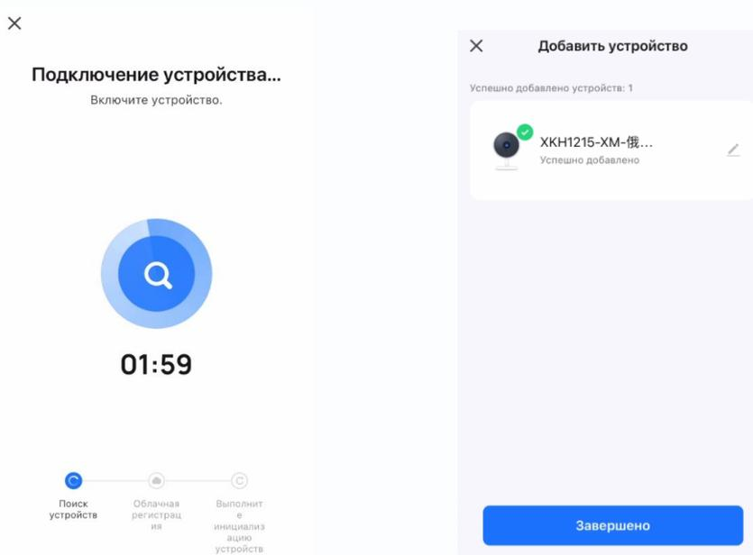
Появится экран с процессом подключения камеры, а следом за ним экран с надписью: «Успешно добавлено». При успешном подключении камера произнесет «Add device success». Нажав значок редактирования, можно изменить имя устройства. Затем нажмите **Завершено**.
