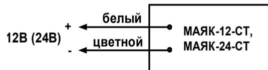
Рис.1. Схема подключения.
