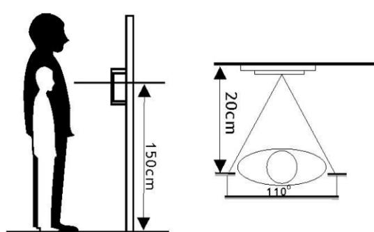
1. Выберите подходящее место установки вызывной панели. При выборе места установки избегайте возможности попадания прямого солнечного света или встречного освещения на видеокамеру.
