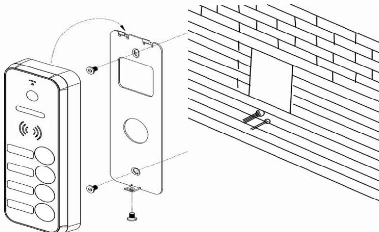
1. Просверлите в стене отверстия под кабели и крепеж кронштейна на нужной высоте.
