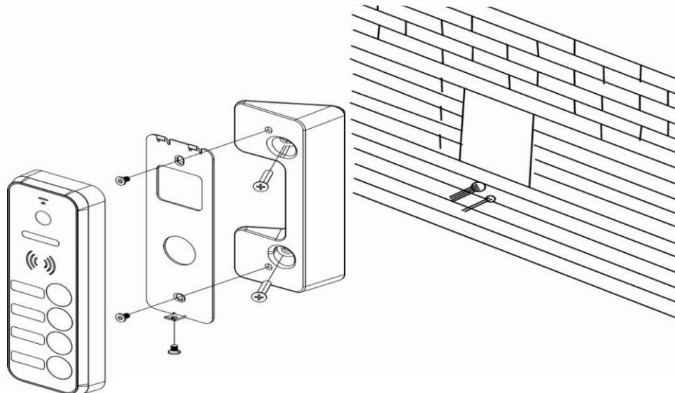
1. Просверлите в стене отверстия под кабели и крепеж углового кронштейна на нужной высоте.
