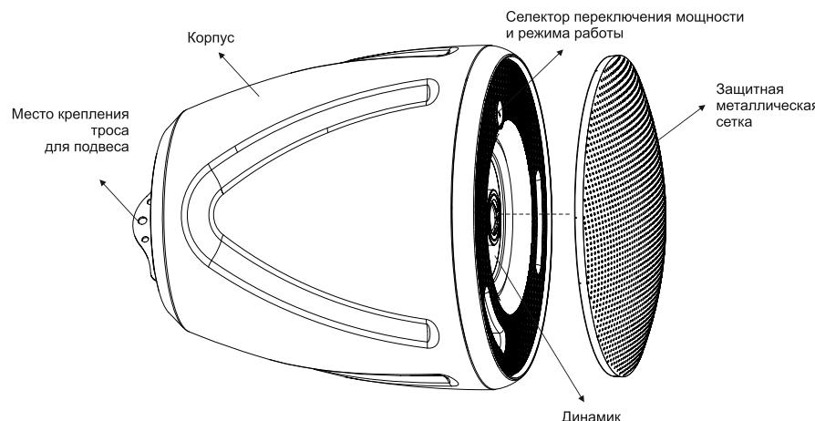
Корпус акустической системы изготовлен из прочного ABS пластика. Лицевая защитная панель из металла окрашенного в цвет корпуса. Данная модель выпускается в двух цветах:
