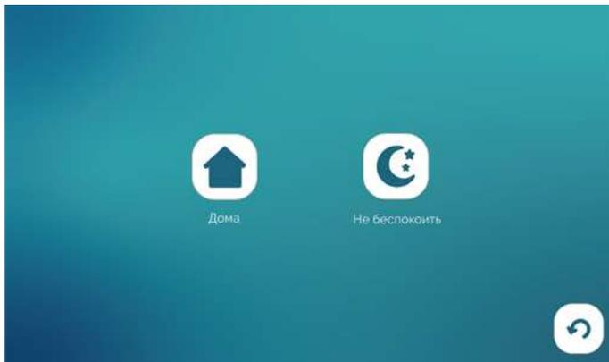
Режим **Дома** – основной режим работы монитора. В этом режиме уведомления о событиях производятся со звуком. В режиме **Не беспокоить** монитор работает без звуковых уведомлений.
