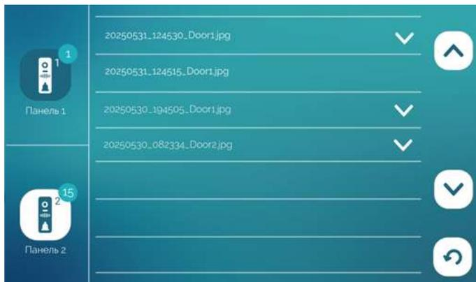
Фотографии, сделанные с камеры панели 1, отображаются на вкладке **Панель 1**; с камеры панели 2 – на вкладке **Панель 2**.
