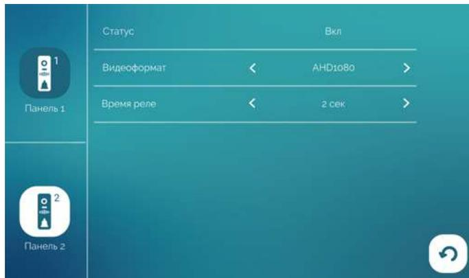
Панель 1 всегда включена, ее статус нельзя изменить. Если к вашему монитору подключена только одна вызывная панель, перейдите на вкладку **Панель 2** и установите значение **Выкл** в строке **Статус**. В этом случае монитор будет пропускать пустой экран этого канала при переключении каналов в режиме просмотра (⇒ раздел **6.1 Режим просмотра** на стр. 13).
