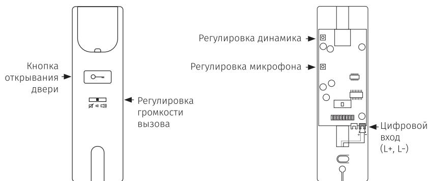
Если трубка подключается к координатной домофонной системе Визит, Элтис, Цифрал, Метаком и прочим, то линия аудио трубы уже подключена к коммутатору с номером квартиры, поэтому провода от трубы достаточно подключить к устанавливаемому переговорному устройству по двум контактам Дес+ и Ед-.
