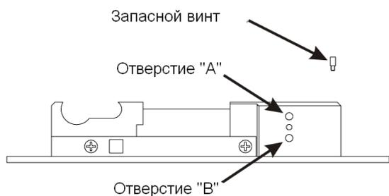
Шаг 2. Сдвинуть ригель замка в среднее положение так, чтобы из Отверстия «А» можно было выкрутить винт.
