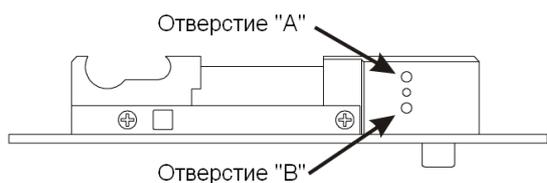
Шаг 4. Выкрутить из Отверстия «А» винт и установить его на место Запасного винта, т.е. в корпус замка.
