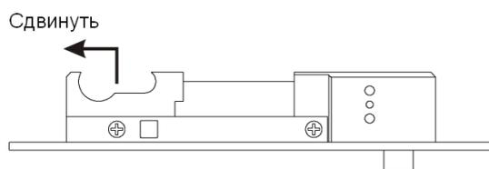
Шаг 3. Удерживая ригель замка в среднем положении закрутить Запасной винт в Отверстие «В».
