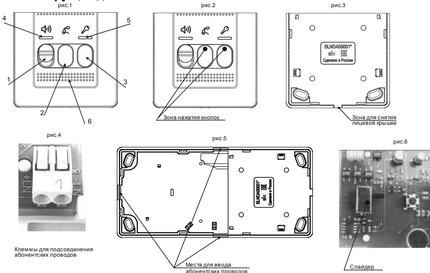
На рис.1 обозначены следующие элементы управления и индикации:
