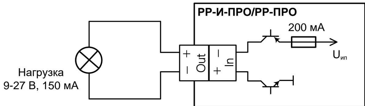
Схема подключения выхода типа "Открытый коллектор с контролем целостности цепи до нагрузки".
