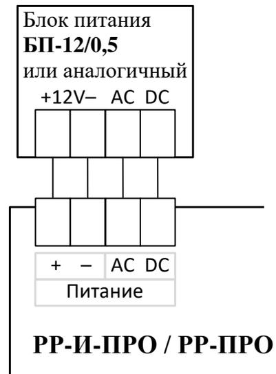
Для питания контроллеров возможно использование резервированного блока питания "БП-12/0,5" производства "Аргус-Спектр" с несущей панелью, позволяющей закрепить прибор непосредственно на блоке питания и выполнить все соединения внутри корпуса.
