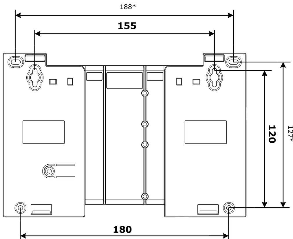
После навешивания контроллера он закрепляется на стене путём ввёртывания одного, либо двух дополнительных шурупов.
