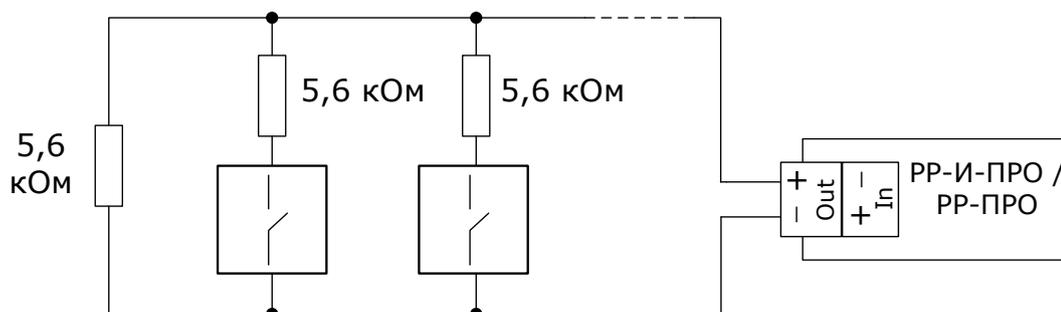
Определение срабатывания двух извещателей ("Внимание"(Пожар1) и "Пожар") возможно только при включении в свойстве "Принятие решения о пожаре" соответствующей зоны КСГ параметра "Алгоритм В" или "Алгоритм С". В этом случае, на схеме на предыдущем рисунке последовательно включенные с пожарными извещателями резисторы должны иметь сопротивление 2 кОм.
