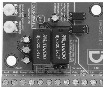
При регулировке не используйте усилие, винт регулятора должен вращаться легко на угол около 300°. Для вращения рекомендуется использовать небольшую отвертку. После настройки уровней соберите модуль обратно и уберите в предназначенное для него место.
