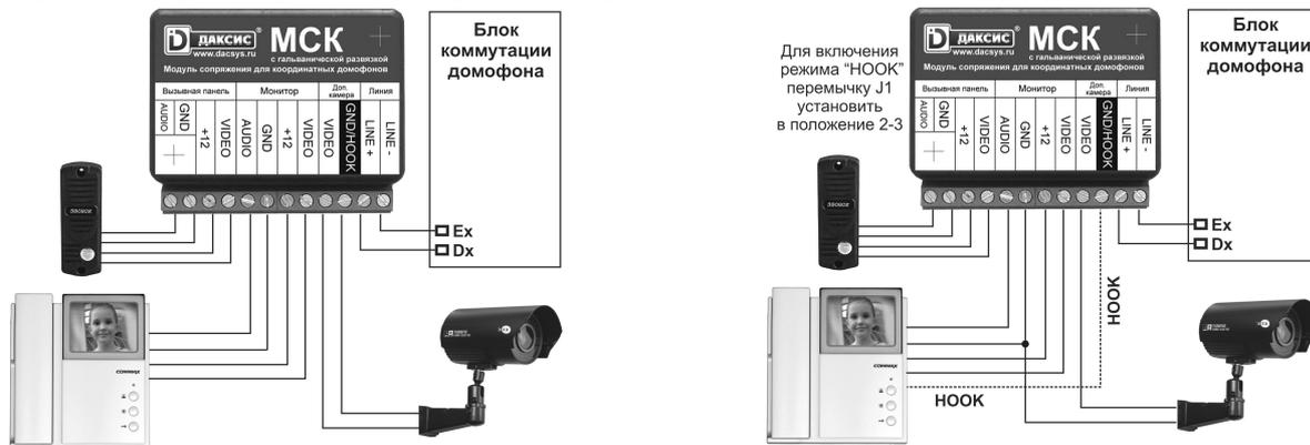
При подключении по правой схеме не забудьте перевести переключку J1 в положение 2-3, при этом назначение клеммы 10 переключится из GND во вход сигнала HOOK. Общий провод сигнального кабеля подъездного видео нужно подключать к любой другой клемме GND (2 или 6) в такой конфигурации. Данная схема подключения действительна только для модулей сопряжения МСК версии 2d и выше.
