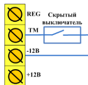
Рис. 4.8. Схема подключения скрытого выключателя или кнопки
