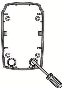
Провести провода от источника питания и шлейфа сигнализации через отверстие для ввода проводов в основании извещателя
