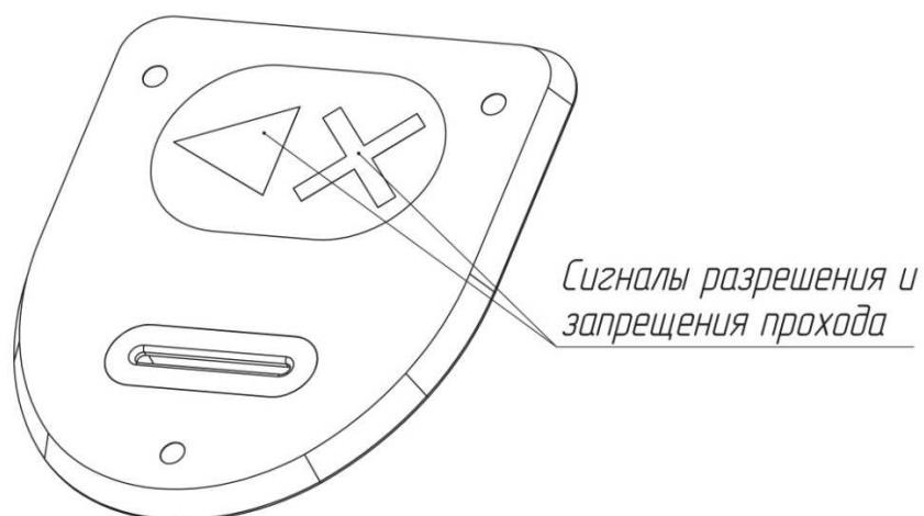
Рис. 4. Внешний вид панели индикации картоприемника
