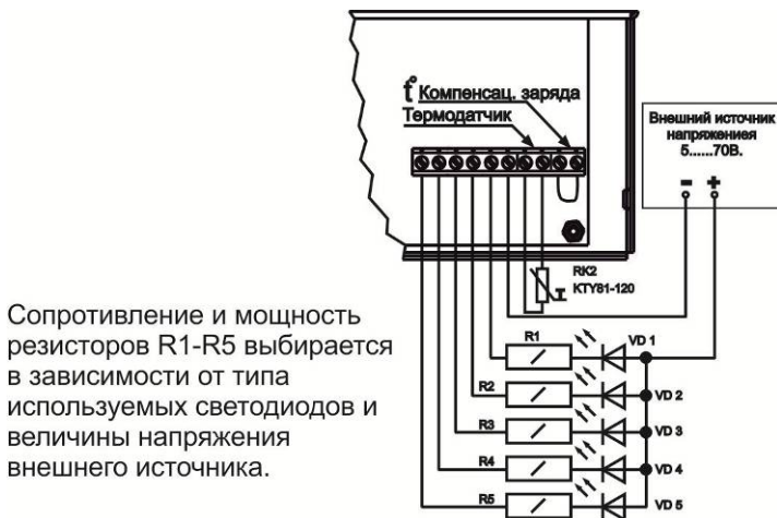
Рисунок 7 – подключение внешних цепей индикации
