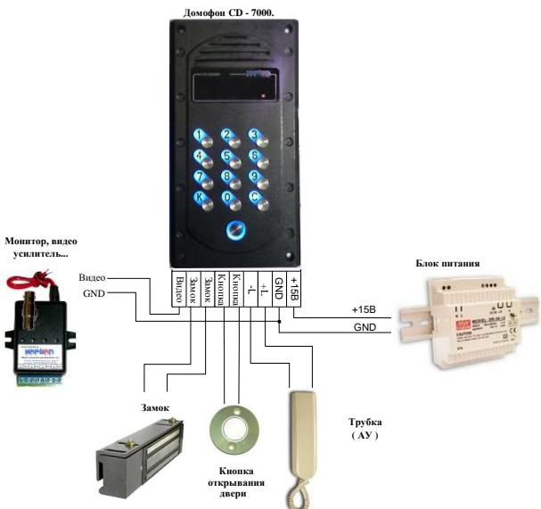
Все соединения должны быть выполнены проводом сечением не менее 0,75 мм<sup>2</sup>.
