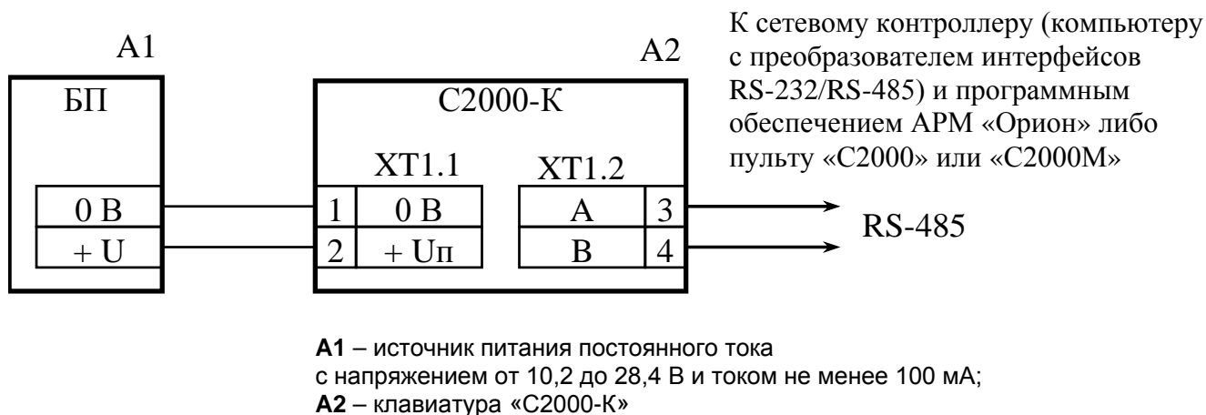
Рисунок 1 Схема подключения клавиатуры «С2000-К» при эксплуатации
