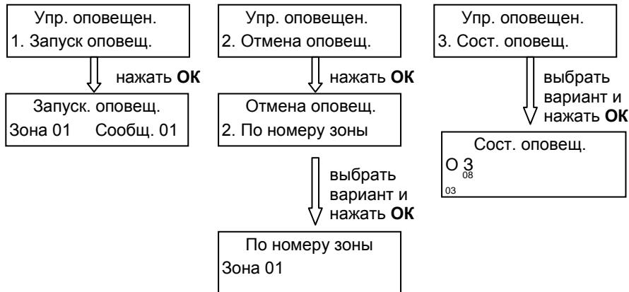
Выбор зон производится из списка, пролистывание которого обеспечивается кнопками ▼, ▲, либо цифровыми кнопками.
