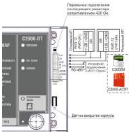
Рисунок 2. Схема внешних соединений блока «С2000-ПТ»
