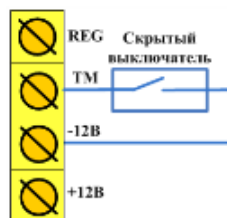
Рисунок 6.4 — Схема подключения скрытого выключателя
