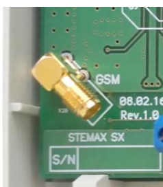
Рисунок 6.3 — SMA-разъем для подключения GSM-антенны
